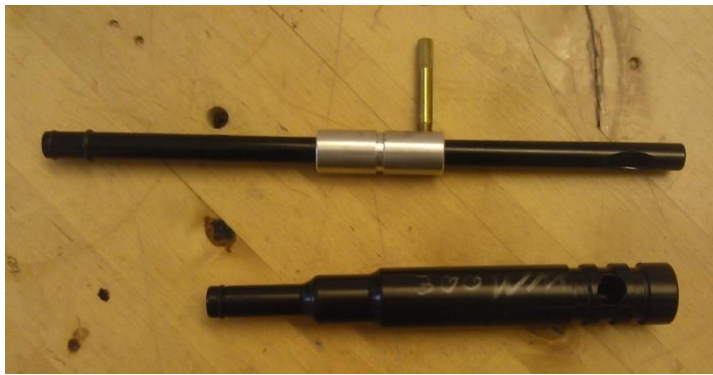
Putzstockführungen mit Solventport
