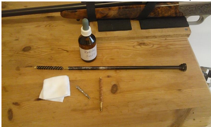
Patronenlagerputzstock, Bronzebürste, Spitze, Patches und Pipettenflasche für Solvent
